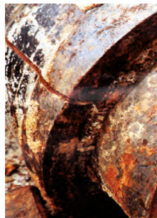
EFFETS DE LA CORROSION EXTÉRIEURE ET INTÉRIEURE SUR LES TUYAUTERIES
