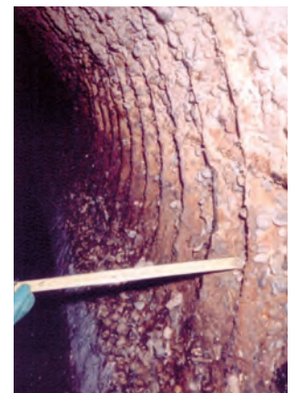
EFFETS DE LA CORROSION EXTÉRIEURE ET INTÉRIEURE SUR LES TUYAUTERIES
