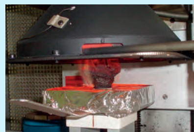
Les échantillons en PVC doivent augmenter leur épaisseur initiale d'au moins 800% pour obtenir la marque NF Me
